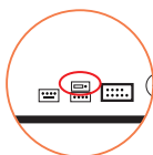
图2-1 清除CMOS 跳线
