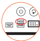
图2-1 清除CMOS 跳线
