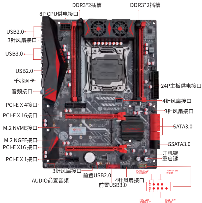
图1-1 X99-AD3 V3.0 主板图解
