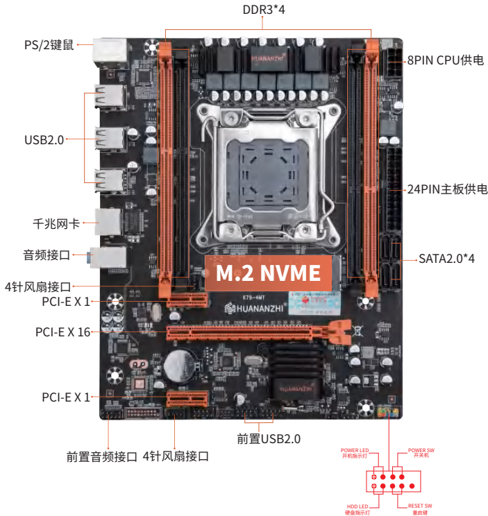
图1-1 X79-4MT主板图解
